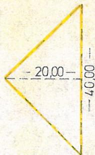
SICHTDREIECK MIT ANGABE DER SCHENKELLÄNGE. SICHTDREIECKE SIND STÄNDIG VON JEDER SICHTBEHINDERNDEN BEBAUUNG, BEPFLANZUNG UND ABLAGERUNG VON MEHR ALS 1,00 m HÖHE ÜBER FAHRBAHNOBERKANTE FREIZUHALTEN.
