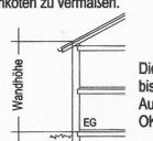
Die Wandhöhe ist von OK-EG Rohfußboden bis zum Schnittpunkt der verlängerten Außenkante Mauerwerk mit der OK Dachhaut zu messen.
