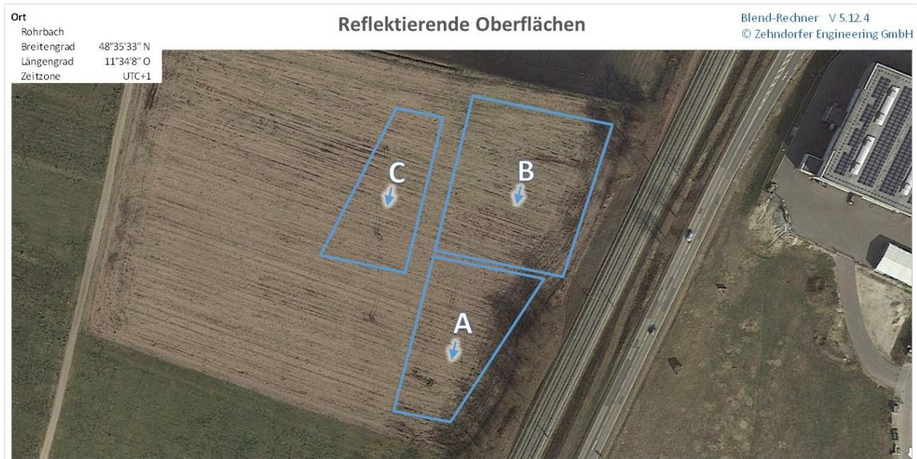
Die PV-Anlage wurde für die Berechnung in drei Vierecken modelliert.
