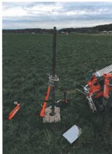
Foto 2: Durchführung des Schrägzugversuchs: Durch den Kolbenhub des orangen Hydraulikzylinders wird eine Belastung unter Windsog in dem
