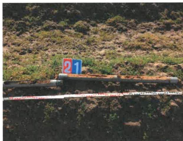
Foto 3: Typisches Bodenprofil für das Projektgebiet: Ein direkter Punktaufschluss wird hier mit einer Rammkernsondierung (Durchmesser 60 mm)
